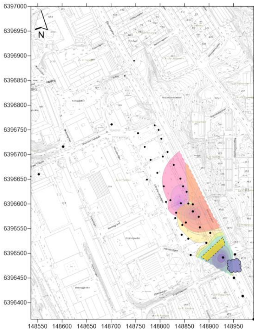
Figur 10.1. Situationsplan över Gibraltarvallen med föroreningsplym och åtgärder enligt Åtgärdsalternativ 2 och 3. Gul markering avser filter skapat genom injektering av flytande aktivt kol. Blå markering avser lokaliseringsområdet för åtgärder.
